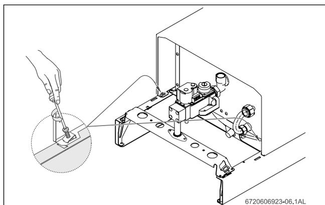
Рис. 12. Снятие передней крышки
