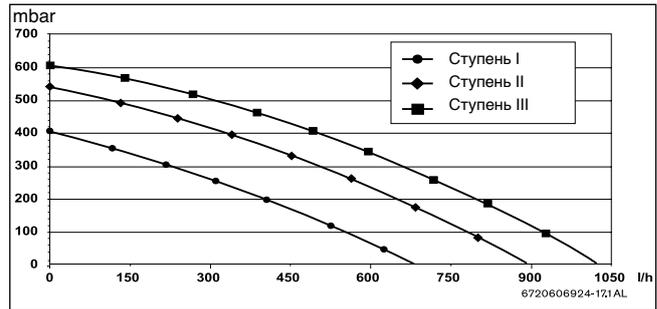
Рис. 6. Характеристика работы насоса
