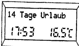
Начиная с этого момента, регулятор устанавливает в помещении температуру, заданную на регуляторе C (m). Количество дней, оставшееся до конца отпуска, показывается на дисплее. По истечении заданных дней, регулятор заканчивает пониженный режим и возвращается в автоматический режим.
