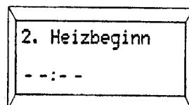
Указание: **- - : - -** означает, что этот период не задействован, то есть согласно заводской настройке, или после долгого отсутствия электропитания запрограммированы только 1 нормальный и 1 пониженный режим.
