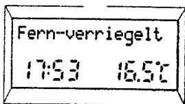
После открытия контакта, например, телефонный сигнал, регулятор работает в предварительно установленном режиме.
